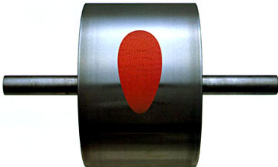
ホルベインでは油絵具の製造が終わると、4工程の製品テストを行います。中でも油絵具の置き味や伸びに影響する「粘稠度」を調べるのがスライドメーターという測定器具。まずは、非常に重い調整ロールで絵具を押しつぶします。そして、大きな押型に押しつぶされた油絵具の、かたちの広がり具合によって粘りやさくみを計ります。絵具は精密な製品。いくつものテストを乗り越えて、ようやく製品になるのです。ホルベインの命は品質です。
